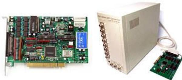
PCIバスを採用した分解能12bitの高速A/Dコンバータ
