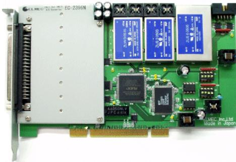
EC-2396Nは“大容量アナログデータ収録”を可能にする計測ボードで、1枚のボードで16bit・1MHz・8CHの同時サンプリング計測ができます。(各チャンネル最大1MHz)
