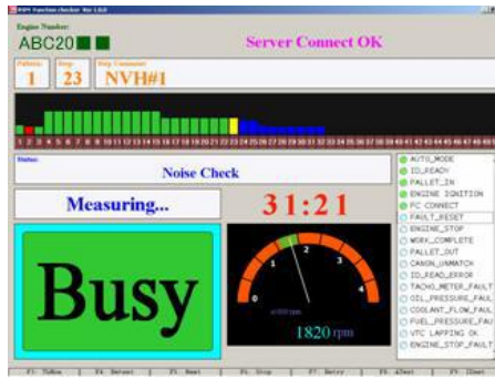
ファイアリングテストベンチ音振判定中
