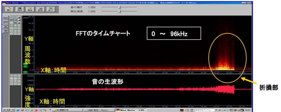
図 1-2 ドリルの刃 折損時2
